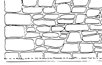
2) Bruchsteinmauerwerk (opus antiquum) mit Eckverquaderung
