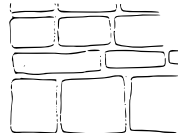
9) Hausteinmauerwerk, ungleichhohe Schichtung
