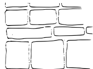
9) Hausteinmauerwerk, ungleichhohe Schichtung
